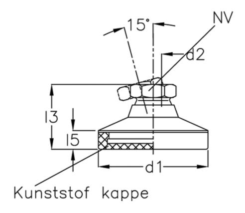
d1 = 32 d2 = 8 l3 = 24.5 l5 = 6.5 NV = 12 Static load (N) = 7 t min = 9
